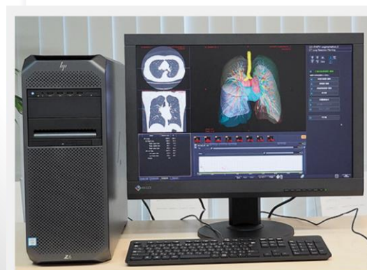
医用画像処理 ワークステーション「Ziostation2」 (HP Z6 G4 Workstation+NVIDIA Quadro RTX 5000を使用)
