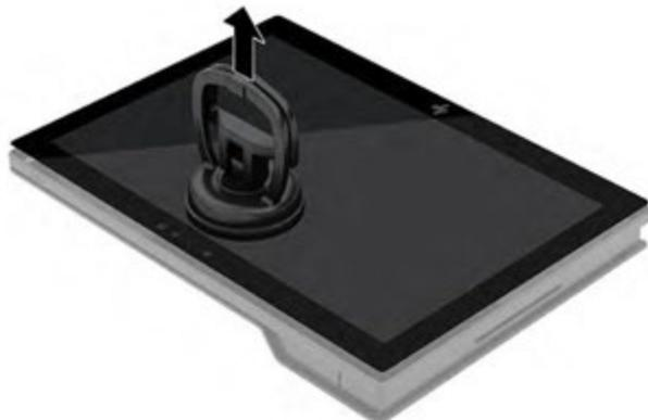
3. 特定の場所で、非導電性の傷の付かない平らな工具を使用して、コンピューターからパネルを外します。次の図の吹き出し(1)～(6)を参照して、外す場所と順序を判断してください。ディスプレイパネルをコンピューターの横に置きます。
