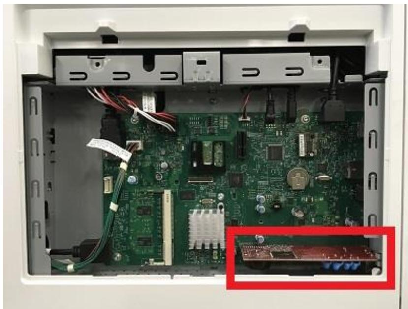
6. インターフェースポートにカバーを取付け、フォーマットプレートを取付けたら、プリンタに電源を入れます。
