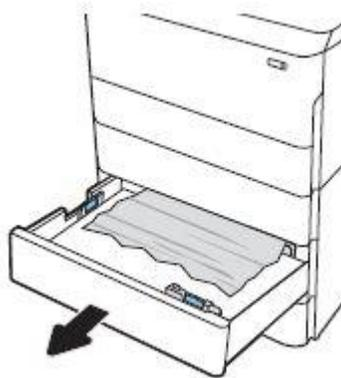
9-2. プリンタ内部のフィード ローラーに詰まった用紙を取り除きます。まず用紙を左側に引き、次に前方に引いて取り除きます。
