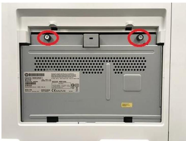
4. 側面にあるインターフェースポートへのアクセスドアを開け、ファックスポートのカバーを取り外します。
