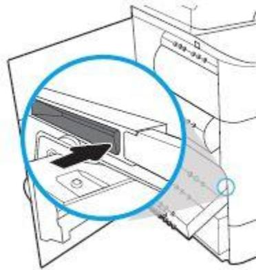
7.サービス用液体コンテナの左端を位置調整のトラックに挿入し、トラックにユニットをセットしているラッチをロックします。
