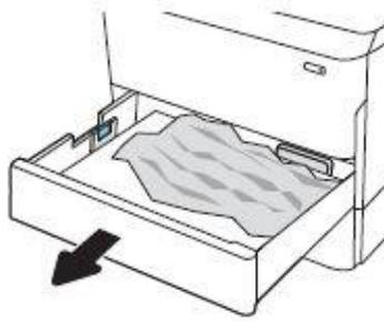
6-7.プリンタ内部のフィードローラーに詰まった用紙を取り除きます。まず用紙を左側に引き、次に前方に引いて取り除きます。
