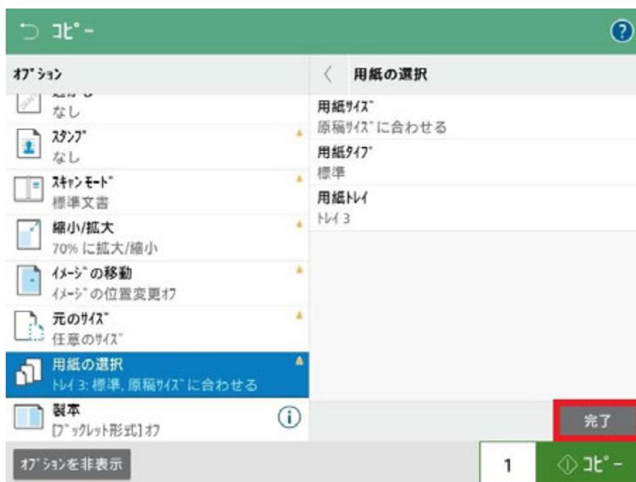
6.コピー枚数を設定します。数字が表示されているボタンをタッチします。
