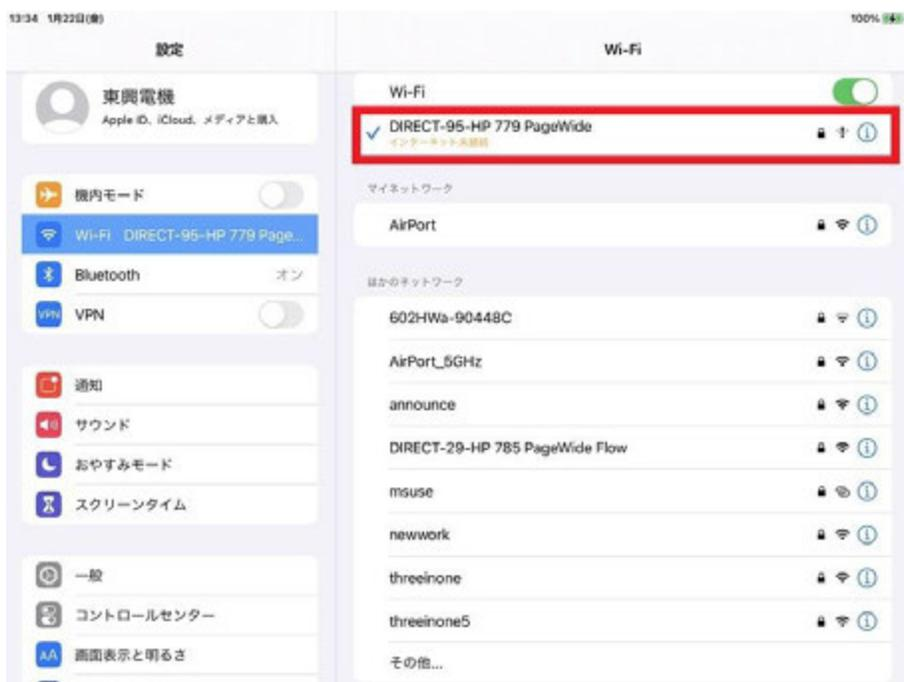
7.Wi-Fi Direct で接続したクライアントデバイスには **192.168.223.xxx** のセグメントの IP アドレスが割り振られます。
