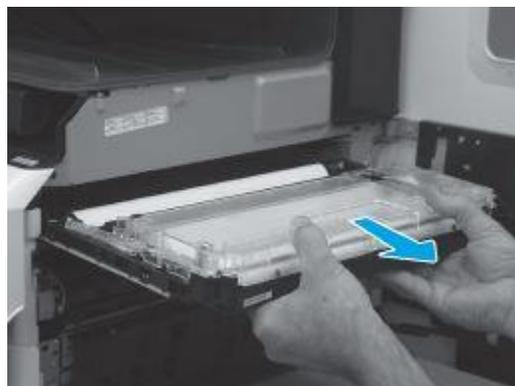
10.新しいプリントヘッドワイパーキットを挿入します。プリントヘッドワイパーキット自体が動き始めるまで、しっかりと押し込みます。
