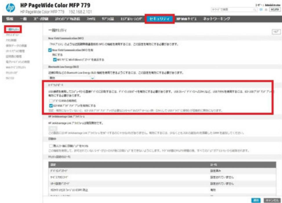
18-2-3.デバイス USB の有効化 チェックボックスにチェックを入れ、OK ボタンをクリックします。
