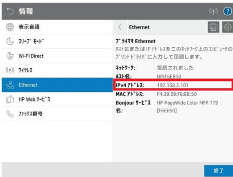
4.クライアントデバイスのブラウザを開き、確認したプリンタの IP アドレスをアドレスバーに入力します。
