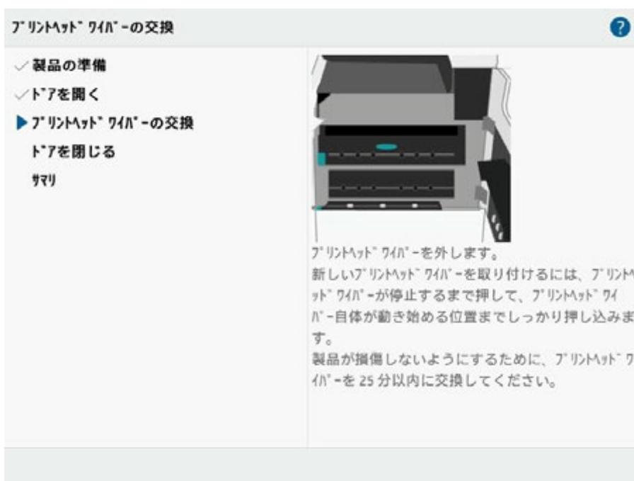
プリンタの右面に、プリントヘッドワイパーキットがイジェクトされているのが確認されます。
