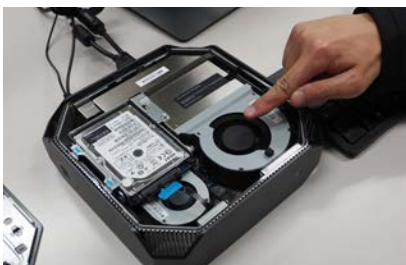
コンパクトな筐体には CPU やメモリー、グラフィックボードなどがぎっしりと配置されている。冷却用ファンも、グラフィックボード用と CPU 用を搭載
