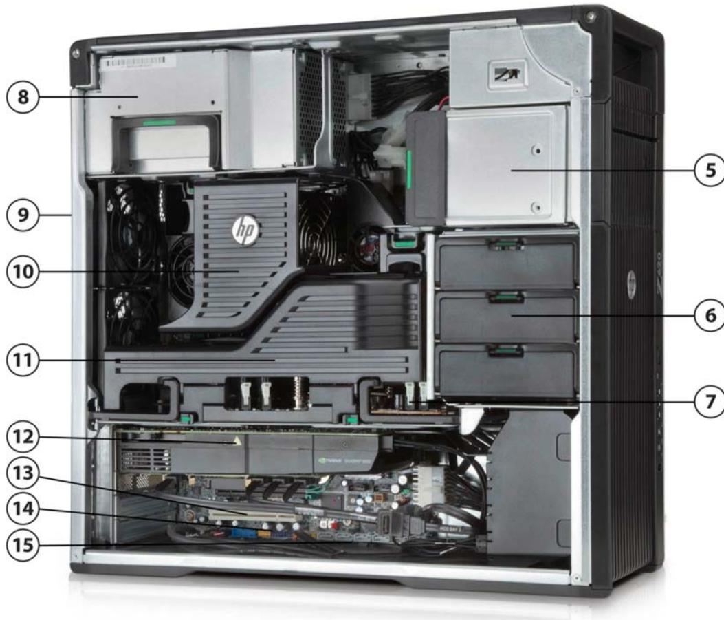
5. 外部 5.25 インチベイ x2 (写真は日本では販売していないスロットロードドライブが装着されています)
