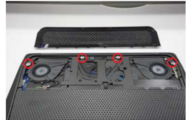
4箇所(赤枠)のネジを外すことで、メモリやストレージの拡張ができる。
