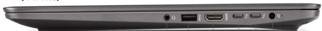
マイク入力/ヘッドフォン出力 USB3.0 HDMI Thunderbolt 3 × 2 (USB-Cコネクタ仕様) 電源コネクタ
