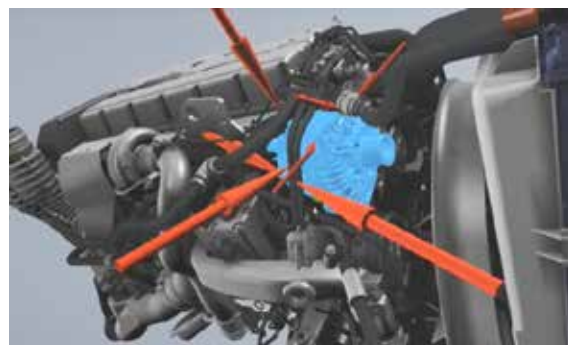
図1 接触時のケーブル変形を考慮したオルタネータの取り出し
