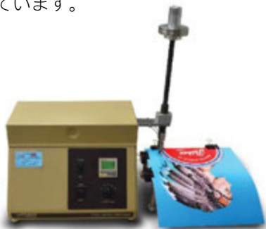
図1 耐擦過性および耐摩耗性は、テーバー式磨耗試験機を使用し、業界の標準試験方法に沿って検証しています。
