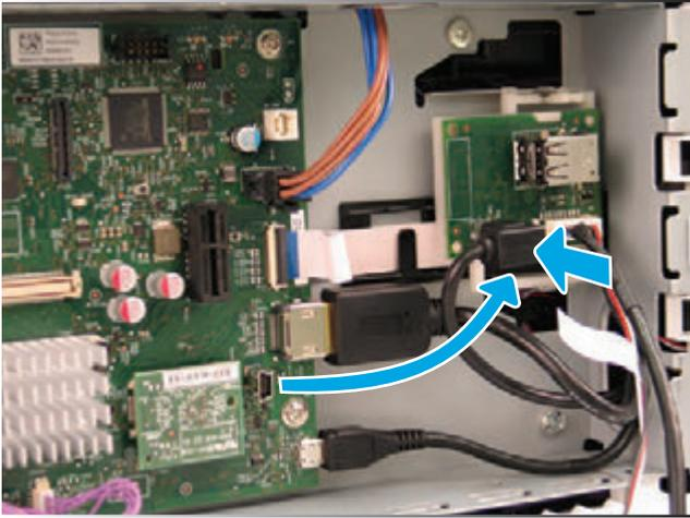
**9** パーツとして取り付けたケーブルの黒いほうを7で空けたスロットへ差し込みます
