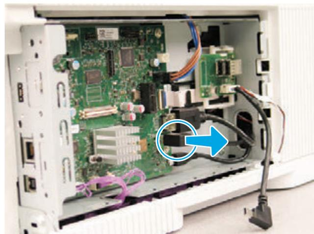
**8** 7で外したケーブルを取り付けたパーツ上のスロットへ差し込みます
