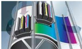
HP が14億ドルを投資したSPT (スケーラブル・プリンティング・テクノロジー) が、より多くのノズルを備えたプリントヘッドの大型化に新たな可能性をもたらしました。新しいHP Edgeline テクノロジーでは、ページ幅全体にわたってプリントヘッドを移動させる設計を採用。プリントヘッドではなく用紙が移動することでプリント速度を高速化し、印刷品質はよりシャープで鮮明になります。
