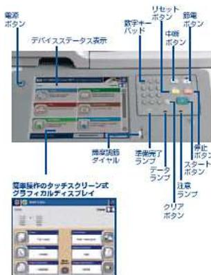
驚くほどシンプルなユーザーインターフェースから、全ての機能をスムーズに簡単に操作することができます。さらに、評価の高い(1) HP Easy Select Control Panel には10インチのフルVGA カラータッチスクリーンと親しみやすいWindows® タイプのアイコンを使用し、設定のカスタマイズが可能。操作が格段にシンプルになりました。また、トラブルシューティングには動画とインジケータランプが、解決の為の作業をサポートします。
