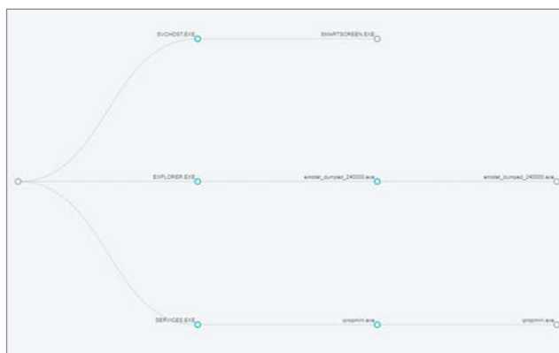
図 43 - emotetet_dumped_240000.exeのBromium Controllerプロセス相互作用グラフ。自分自身を起動し、"ipropmini"というサービスを作成し、15.exeで示された動作と密接に一致しています。
