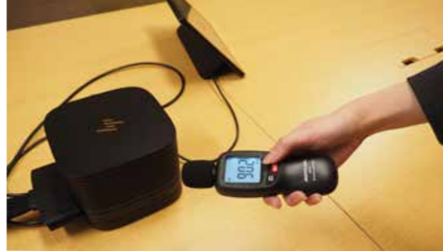
01-3 デシベルチェッカー計測。スペック通りの値が出ました。
